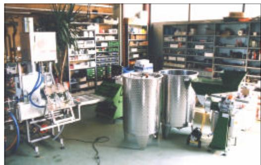
Parmi le matériel de jus de fruits destiné au CSFT, figurent un broyeur, un pasteurisateur, une presse, (offerte par Paul GILSON) deux cuves en inox ainsi que du petit matériel de laboratoire pour l'expérimentation d'une recette appropriée.
